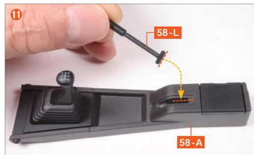
將手煞車桿 58-L 的 T 字形前端對準 58-A 的細長孔插入, 並將其嵌入 58-A 背面的方形框中。
