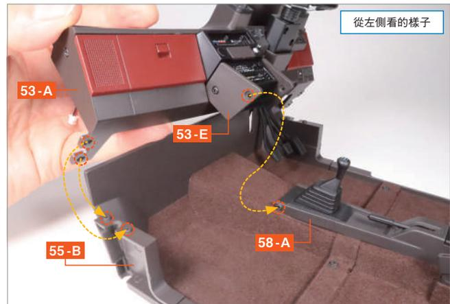
首先，將中央控制台側面板 (R) 53-F 和中央控制台側面板 (L) 53-E 的螺絲孔凹槽，分別對準 58-A 前端左右兩側的螺絲孔突起部分。接著，將下儀錶板 53-A 左右兩側各兩處的螺絲孔凹槽，分別對準前圍側裝飾板 (R) 55-C 和前圍側裝飾板 (L) 55-B 上兩處的螺絲孔突起部分。
