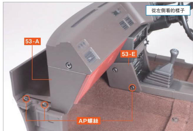
使用 AP 螺絲 固定步驟 16 中組裝好的左右各3個螺絲孔。
