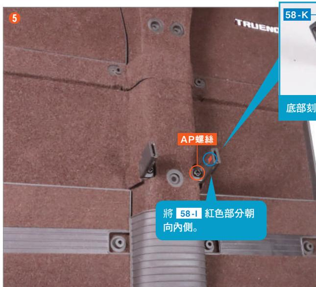
與步驟③相同，將另一個 58-K 嵌入內側安全帶固定座 (R) 58-J，對準 55-A 的螺絲孔，並使用 AP 螺絲 固定。
