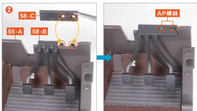
從上方壓住在步驟①中組合好的 58-B，將踏板支架 58-C 的兩處螺絲孔凹槽與 55-A 的螺絲孔突起部分對準嵌入，並使用 AP 螺絲 固定兩處。
