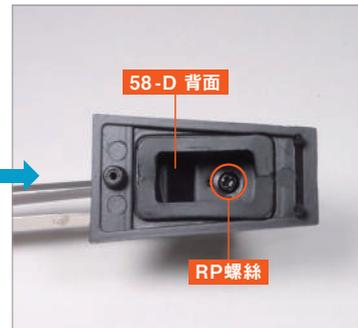
將變速桿 58-D 的圓形螺絲孔和方形突起部分, 對準 58-E 的洞孔和缺口嵌入, 然後從背面使用 RP 螺絲 固定。
